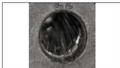
A mola de lâmina da tomada de recarga ou a parte inferior do terminal estão escurecidas e deverão ser substituídas.
