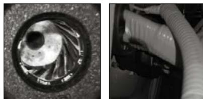
A mola de lâmina da tomada de recarga e a parte inferior do terminal estão amareladas, a parte traseira do cabo de recarga está escurecida e deformada e deverão ser substituídas.
