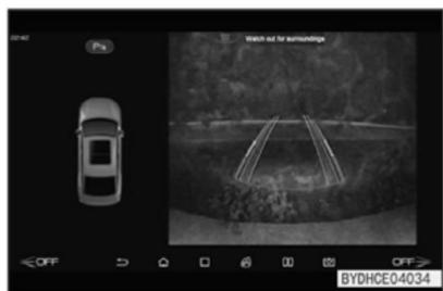
Durante a marcha à ré, o sistema do sensor de estacionamento alerta o motorista sobre a distância entre o veículo e algum obstáculo por meio da luz indicadora do sistema multimídia (se disponível) e do alerta sonoro no alto-falante. Este sistema detecta obstáculos através de sensores.
