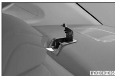
2. Levante o encosto da cabeça e abra a cobertura da base da ancoragem.
