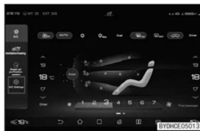
Toque neste botão para acessar a interface de configuração do ar-condicionado.
