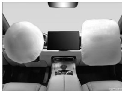
O airbag do motorista está localizado no volante de direção e o airbag do passageiro está localizado no painel de instrumentos.
