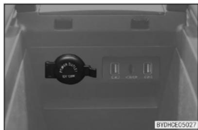
A tomada auxiliar pode fornecer energia para acessórios cuja tensão de operação é 12 Vcc e cuja corrente de operação não ultrapasse 10A.
