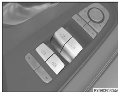
O sistema do veículo deve estar ligado para o funcionamento dos vidros elétricos.
